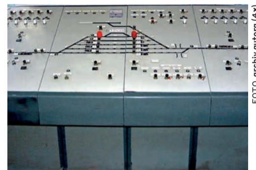
Typové elektrické stavědlo TEST
