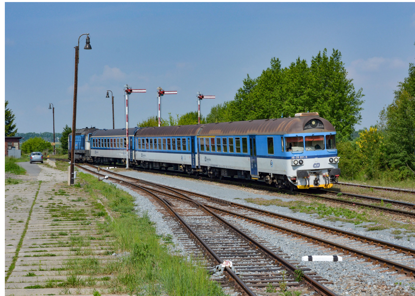
Současná podoba spojení Kladna s Prahou: rychlík s motorovou lokomotivou projíždí kolem mechanických návěstidel ve stanici Jeneč
