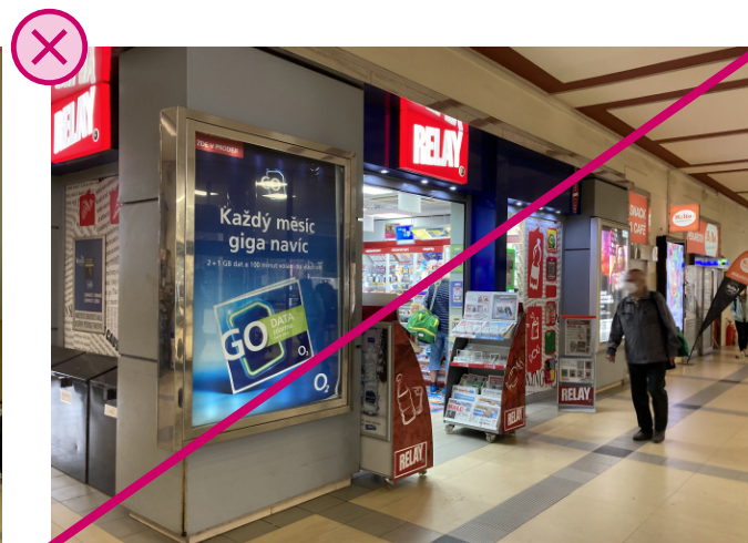
Nikdy se neinstaluje CLV panel v rámu, který přečnává svůj podklad.
