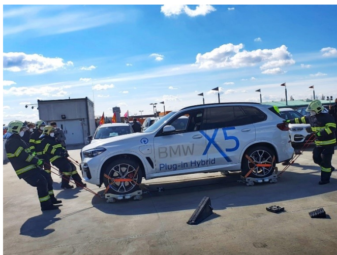
Obrázek 5: Speciální vozíky na manipulaci s elektromobilem
