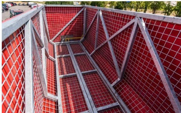
Obrázek 3: Příklad kontejneru, který se dá použít při zásahu zahoření elektromobilu [11]
