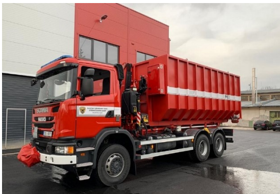
Obrázek 3: Příklad kontejneru, který se dá použít při zásahu zahoření elektromobilu [11]
