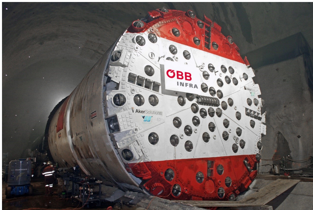
Foto 6: Jeden ze tří tunelovacích strojů pro ražbu Koralmského tunelu (rok 2012) Zdroj: ÖBB-Infrastruktur AG [16]
