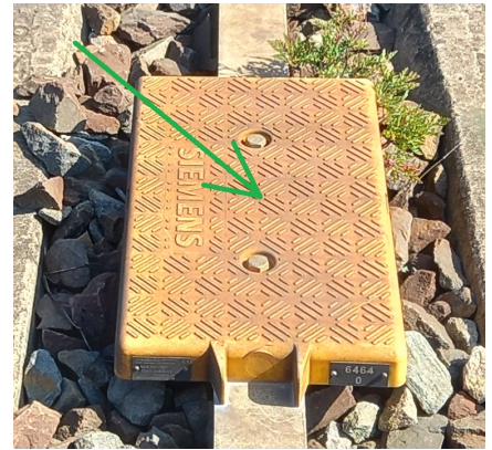
detail - číslo vyražené na štítku balízy ETCS
