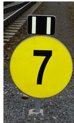
Na sloupku, předvěstník "7" = pořadí 1, zkrácená vzdálenost = bez pořadí.
