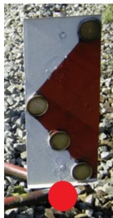
Trvalé návěstidlo upevněné na kolejnici - detail.
