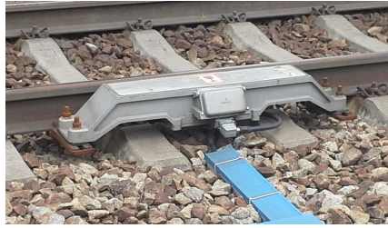
stacionární část vlakového zabezpečovače rakouských drah (GPE, INDUSI)
