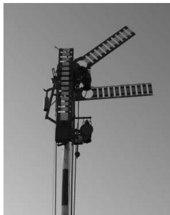
na stožáru, tříramenné mechanické návěstidlo
