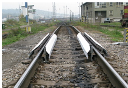
Kolejové brzdy s nainstalovaným protihlukovým zařízením.
