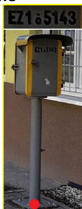
samostatně stojící elektromagnetický zámek (netypická skříňka)
