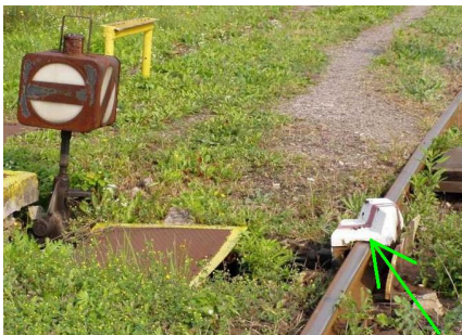
výkolejka levostranná s návěstním tělesem (a přestavníkem)
