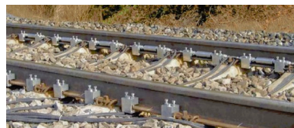
diagnostický systém - detektor plochých kol, výrobce Signalbau
