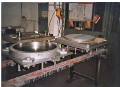
a) Obr. 2.35 – Hrnková ložiska: a) rozložené (hrnec a víko s kluznou vrstvou), b) víko uložené na hrnec (na horní ploše víka je kluzná vrstva s vodící lištou pro jednosměrně posuvné ložisko), c) kompletní ložisko s kotevními trny na horní i na dolní desce
