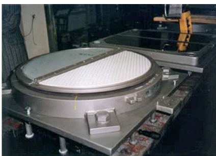
a) Obr. 2.35 – Hrnková ložiska: a) rozložené (hrnec a víko s kluznou vrstvou), b) víko uložené na hrnec (na horní ploše víka je kluzná vrstva s vodící lištou pro jednosměrně posuvné ložisko), c) kompletní ložisko s kotevními trny na horní i na dolní desce
