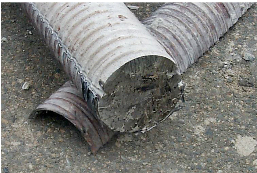
Obr. 2.30 – Příklad kvalitně zainjektovaného kabelového kanálku (po zkoušce injektovatelnosti)
