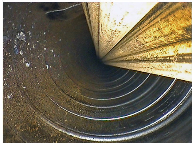
a) b) Obr. 5.211 – Destruktivní sonda k předpínací výztuži, a) zainjektovaný kanálek, b) nezainjektovaný kanálek [2-48]
