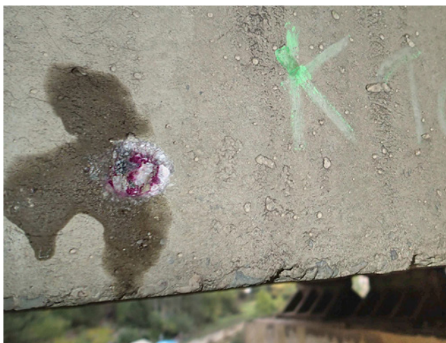
Obr. 5.9 – Zkouška karbonatace provedená přímo na konstrukci
