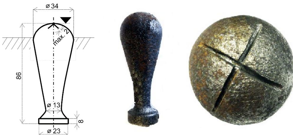
Obr. C.2 - Hřebová nivelační značka N1
