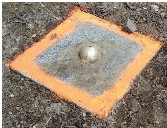
Obr. C.8 - Povrchový kamenný znak M2
