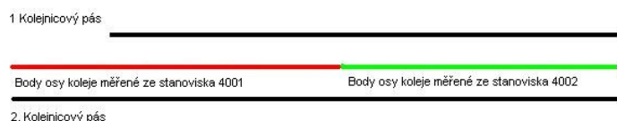
Obr. 2 Měřené a vypočítané podrobné body osy koleje ze sousedních stanovišť 4001 a 4002 po provedení transformace
