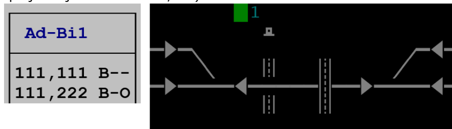
Obrázek 6 – Příklad zobrazení přejezdu s PZM 2 s vazbou na EMZ v mezistaničním úseku
