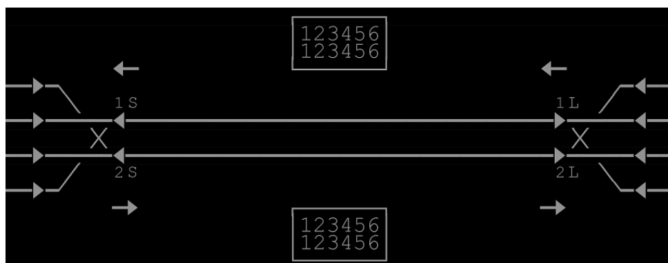
Obrázek 6 - Příklad zobrazení symbolu traťového souhlasu a zásobníků čísel vlaků dvoukolejné trati (JOP řízené oblasti DOZ)
