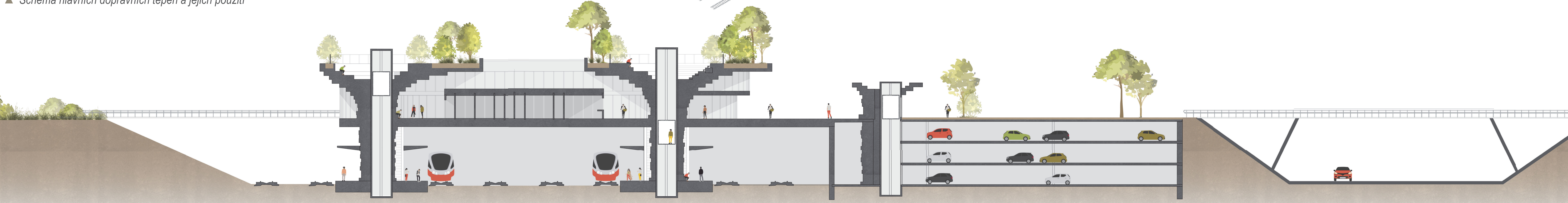
▲ Řez terminálem, podzemním parkovištěm a dálnicí
